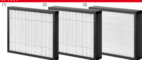
(1) Préfiltre air neuf ISO ePM 10 50% (M5) (2) Filtre pour air repris ISO ePM 10 50% (M5) (3) Filtre pour air neuf ou air repris ISO ePM 1 55% (F7) filtre pour air neuf ISO ePM 1 80% (F9)
